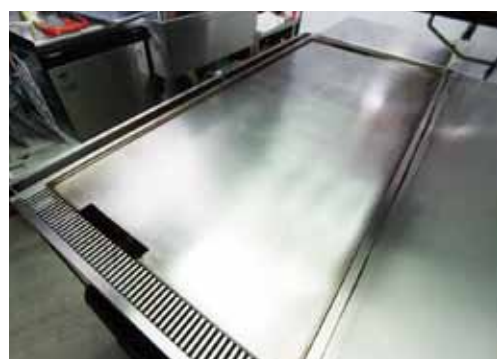
■ 厚み20mmの鉄板を備えた焼台は美味なお好み焼には必須
